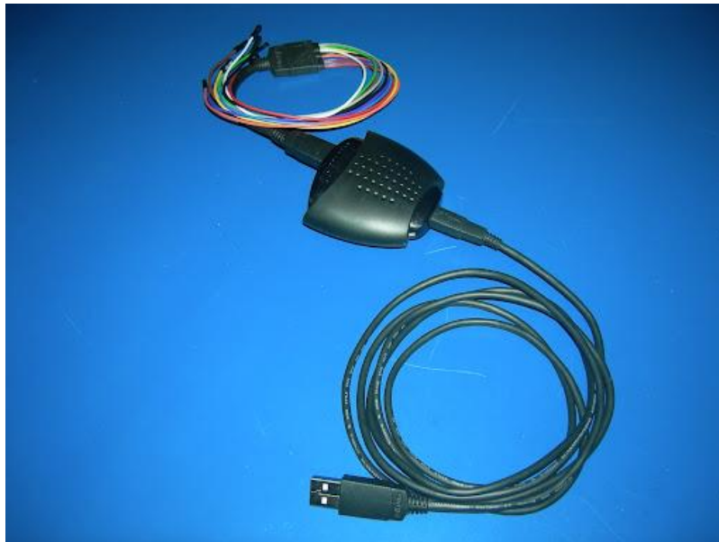
Figure 1 : connecteur JTAG DT01
